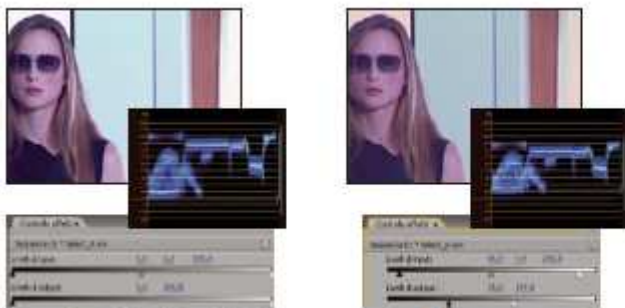
Immagine originale (a sinistra) e con correzione di bianco e nero rientranti negli standard di trasmissione televisiva (a destra)
