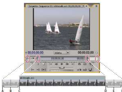
Una clip con le maniglie A. Inizio oggetto multimediale B. Maniglia C. Attacco D. Stacco E. Maniglia F. Fine oggetto multimediale
