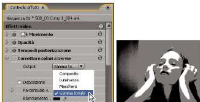
Scegliendo Gamma tonale dal menu Output, vengono visualizzate le regioni di ombra, mezzitoni e luce di un'immagine.
