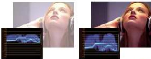
Correggere l'esposizione: Immagine sovraesposta con la forma d'onda nei limiti superiori della scala IRE (a sinistra) e immagine corretta con la forma d'onda entro 7,5 e 100 IRE (a destra)
